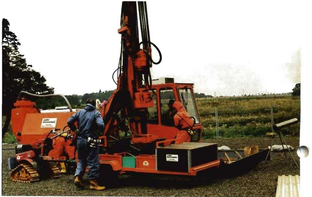
7 Einachs-Raupenschlepper mit Anhänger für den Transport von Personal und Bohrkronen
