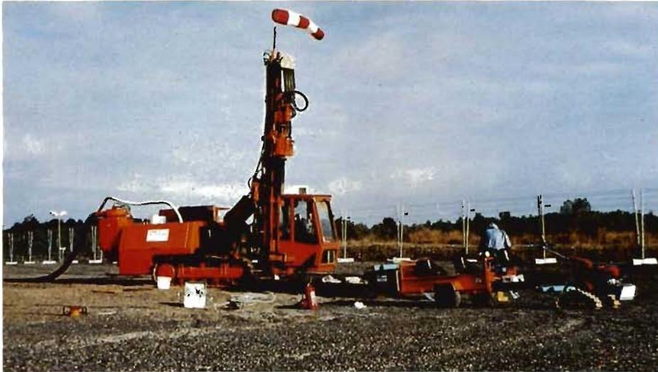
2 Demag Raupenbohranlage Typ CR 90 mit 9,8 t Gesamtgewicht und das Transportfahrzeug
