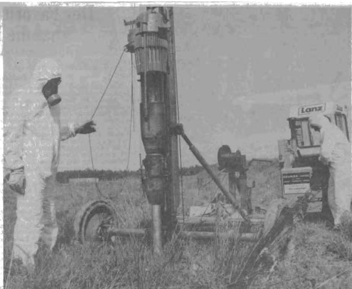
Die Giftmüllkippe wird angebohrt (links). Wissenschaftler nehmen Gasproben aus dem Inneren der Deponie (rechts).
