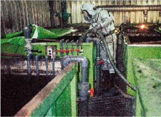
Abb. 9: Betrieb der Reinigungsanlage unter Vollschutz
