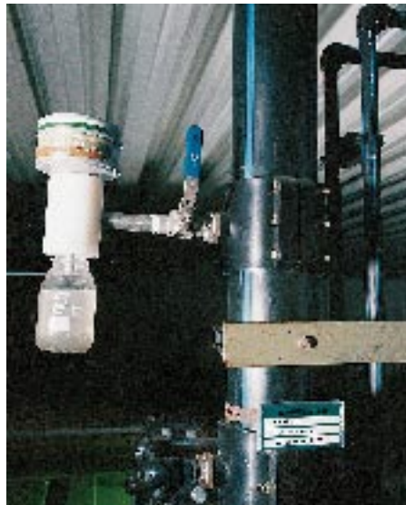
Abb. 16: Das Schauglas zur visuellen Kontrolle des Reaktionsverlaufes
